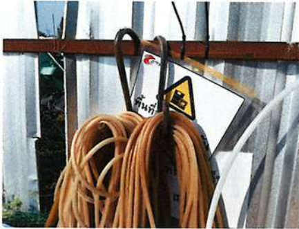
ภาพที่ 2-48 ตะขอตัวเอสสำหรับวางสายไฟนํ้างาน
