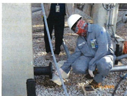
น้ำทิ้งจากกิจกรรมการทดสอบการรับแรงดันของท่อผลิตภัณฑ์ด้วยน้ำ (Hydrostatic Test)
